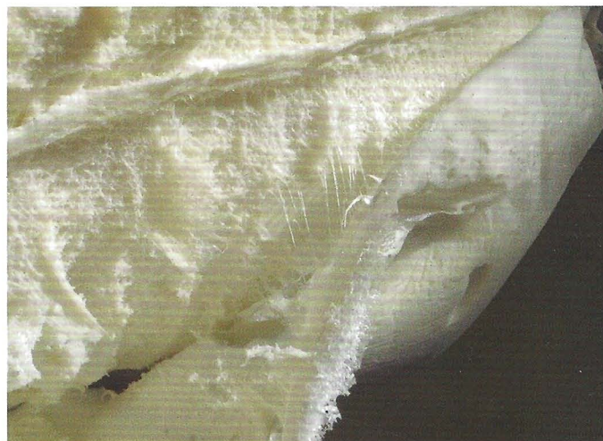
Bild 1 – Weichformschaum – typischer Bauteilfehler: Kollaps und Hautablösungen
